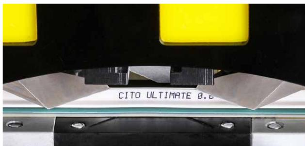
Mit dieser neuen Schneidetechnik, welche die Rillstreifen automatisch an den Schnittkanten anschrägt, entfällt die Nachbearbeitung auf der Stanzplatte nahezu vollständig. Europäische Kunden bestätigen übereinstimmend, dass Rillstreifen, die mit dem AC 3 geschnitten wurden, sofort und ohne weitere Bearbeitung eingesetzt werden können.
